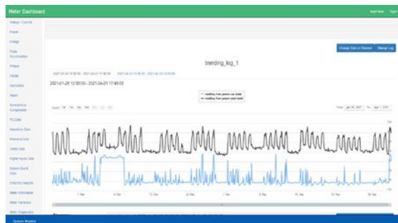
Painel de energia servido pelo próprio equipamento
