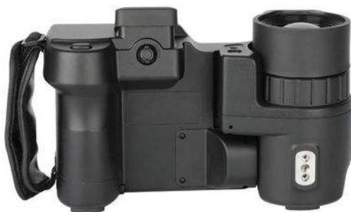
Vista posterior: ecrã tátil, comandos e conectores
