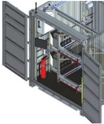
Interior do contentor: estante de dois níveis e unidades de descarga
