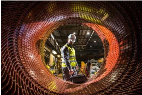
Ensaio de isolamento no estator de uma grande máquina elétrica
