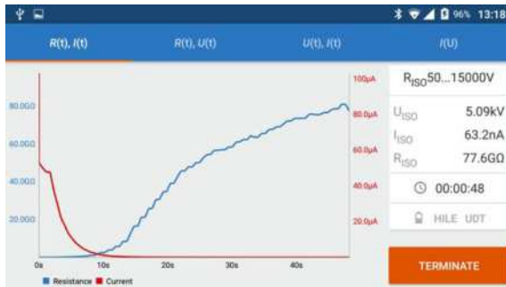
Gráficos de resistência e corrente em tempo real na aplicação móvel durante o ensaio
