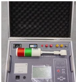
Unidade de controlo com impressora, indicador e bornes de saída e de medição
