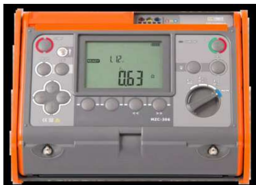
Painel frontal com seletor de funções e ecrã
