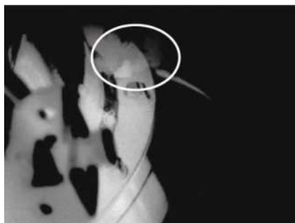
Pluma da fuga vista pelo detetor arrefecido
