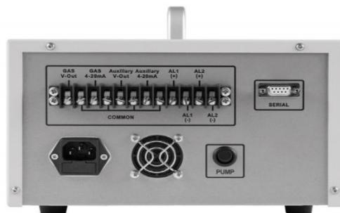
A gama Rapidox 1100 também pode ser utilizada para controlar uma válvula de controlo de caudal proporcional externo (PFC) ou um único relé solenóide utilizando uma saída de sinal remoto (RSO). São excepcionalmente úteis em aplicações de revestimento de gás inerte onde o analisador pode regular o nível de gás com base na medição de oxigénio utilizando a função de controlo PFC ou RSO.
