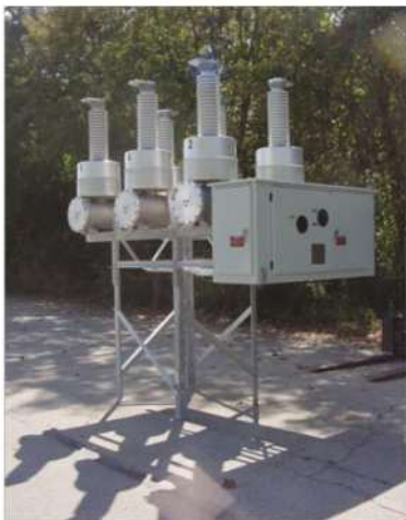
SWITCH- 72,5KV: Peso de SF6: 29lbs- 13kg
