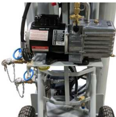
Grupo de bomba de alto vácuo e filtragem
