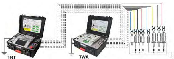
Conexión del TRT400 y TWA400 a un transformador trifásico
